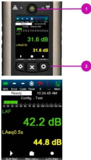
※ SLM mode(타임히스토리 없이 overall 값만 측정)와 LOG mode(타임히스토리 저장 측정)
