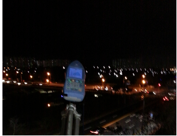
실외소음도 측정 (야간, 고층부)
