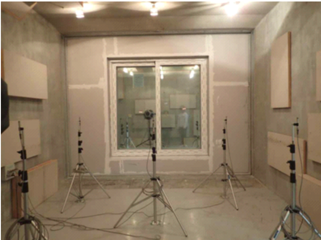
<그림 5-2> 창호의 차음성능 측정
